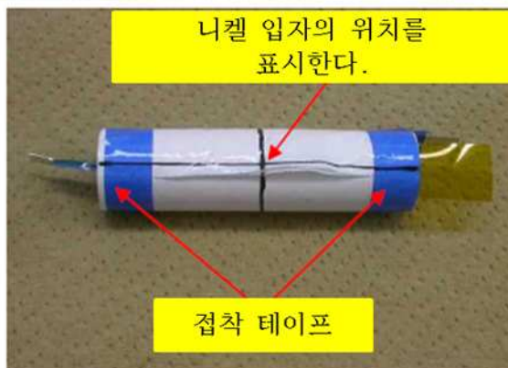
그림 A.5 - 원통형 단전지 해체
